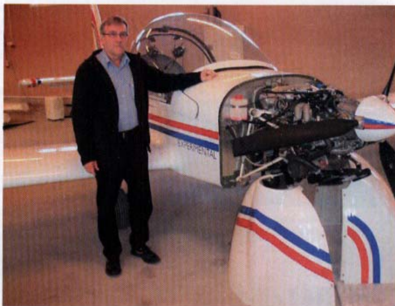
Tampereen ammattikorkeakoulun lentotekniikan linjalla rakennettiin ensimmäisenä Suomessa oppilastyönä lentokone. Laboratoriomestari Jukka Vanne kertoo, että rakennettu Euro Star on ns. ultrakevyt lentokone, jossa on sadan hevosvoiman nelitahtimoottori. Kone valmistui kesällä 2006.
